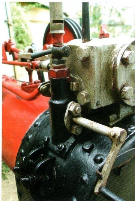
Ci vuole un pò di pazienza per aspettare che il combustibile (legnetti e pezzi di carbonella) nel focolare scaldi l'acqua della caldaia e la metta in pressione poi, con un piccolo aiuto della mano sul volante per vincere l'inerzia iniziale, si fa partire il tutto!
