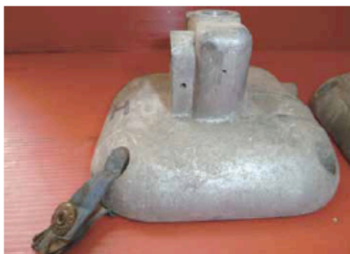
Campana frizione nuova postmodifica (già con il foro)
