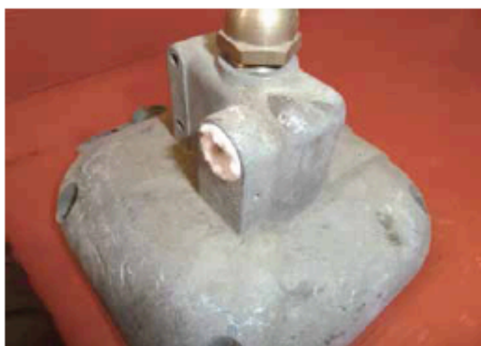
Carter premodifica con anello di guarnizione in feltro montato (02030209) ritenuto non più idoneo per l'evaporazione dei gas generati dall'olio caldo
