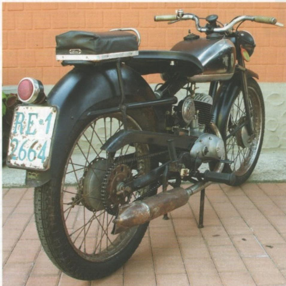
mm, cilindrata 123 cmc, potenza 4,75 Cv a 4800 rpm. Frizione a dischi multipli in bagno d'olio, cambio a 3 marce. Carburatore Dell'Orto MA16. Impianto elettrico con batteria, dinamo e spinterogeno. Velocità max 75 kmh.
