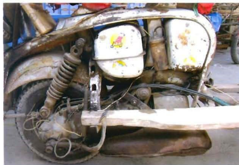
Il triciclo Lambretta (metà LI 150 3° serie del 1965). Si notino (a destra) le molle di ritorno di freno e pedale avviamento, nonché l'adesivo WLC
