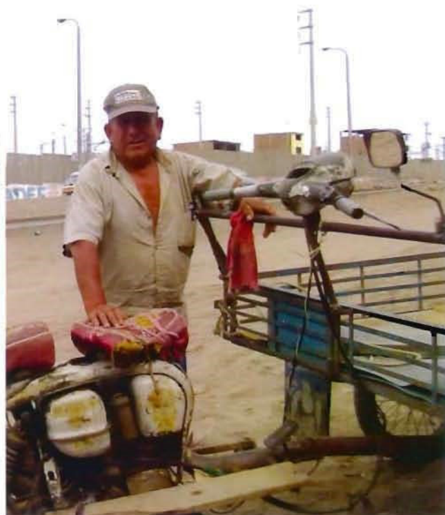
Il triciclo Lambretta (metà LI 150 3° serie del 1965). Si notino (a destra) le molle di ritorno di freno e pedale avviamento, nonché l'adesivo WLC
