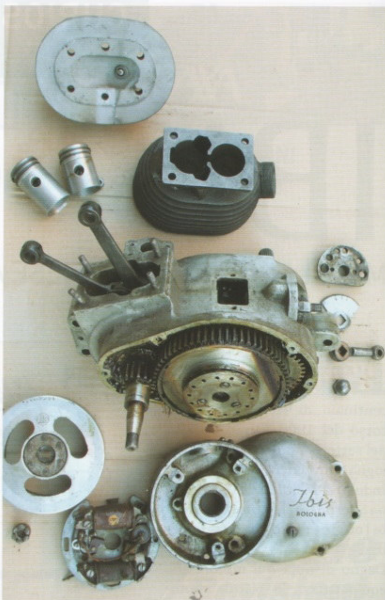
Esplosione generale del motore nei suoi componenti principali
