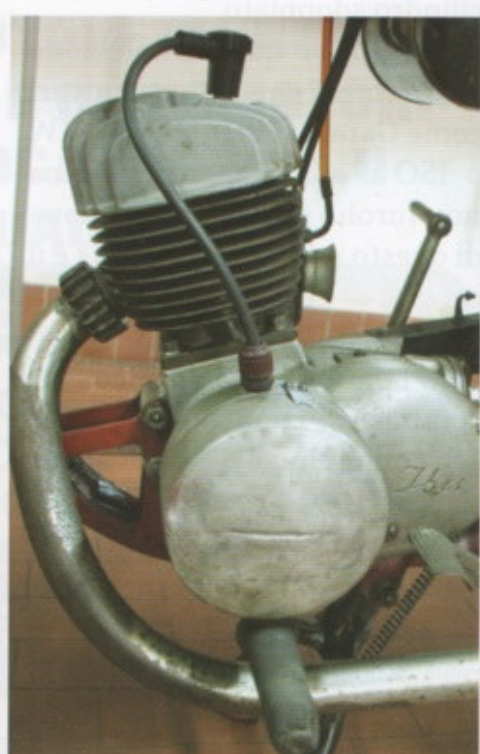
A sinistra: dettaglio selettore marce. Al centro e a destra: dettagli del motore senza valvola rotante che allestisce la motoleggera della collezione Nigelli.
