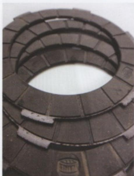
Frizione rivestita con materiale sinterizzato
