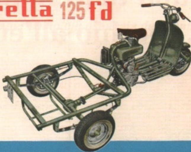
ne del gruppo posteriore è ottenuta con due balestre longitudinali e foglie multiple, con attacco fisso al telaio anteriormente e con biscottino posteriormente. Le tre ruote del
