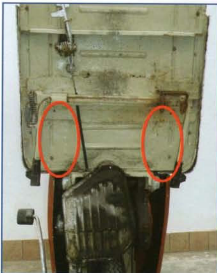
In evidenza nella prima versione non vi è nessun rinforzo sotto al pianale
