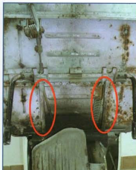
Nella seconda versione in evidenza i traversi di rinforzo sotto al pianale
